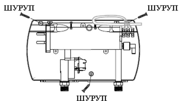
**Внимание! Конструкция стены должна выдерживать 4 массы водонагревателя, наполненного водой.**
